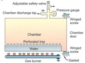
Fig. 5.3: A simple autoclave
